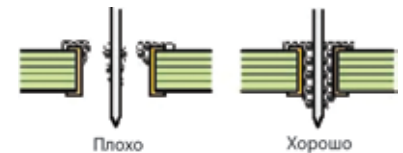
Рис. 40. Если вывод слишком тонкий, припой может не хватить для нормальной пайки в отверстия
