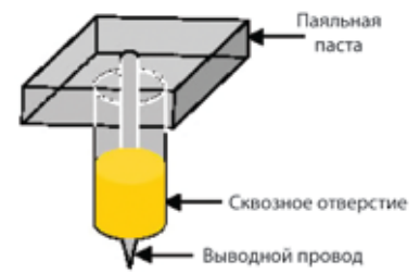
Рис. 39. К расчету количества пасты для нанесения в отверстия
