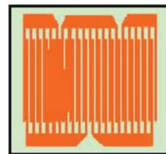
Ширина проводника 0,318 мм. Шаг между проводниками 0,318 мм. Длина нахлеста 15,75 мм.
